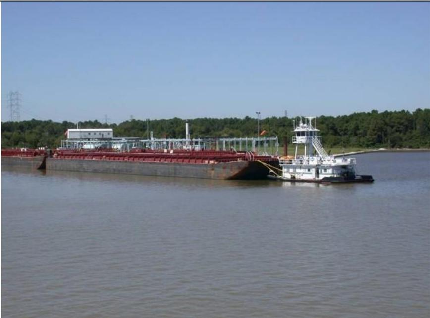
圖 5 密西西比河拖船及駁船連接及頂推駁情形
