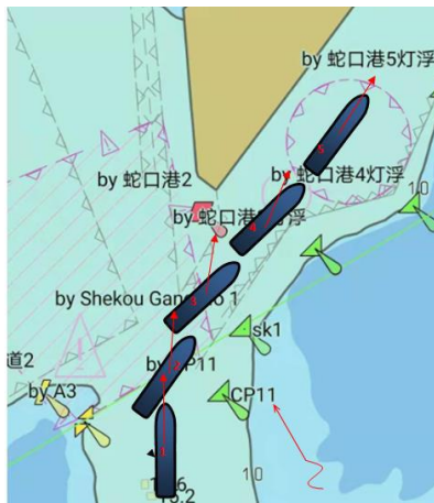
圖 19：控制本船的轉心與速度向量線於預定的航路之前，順流掉頭在受大風強流影响的航段，特別是灣頭航段，要注意搶佔上風上水的有利船位，為安全轉向創造有利條件。
