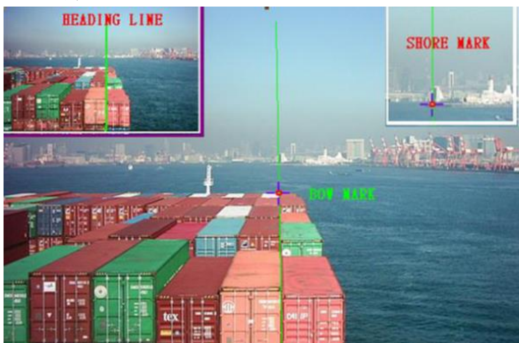
圖 70 倒車時，船頭目標的選擇
