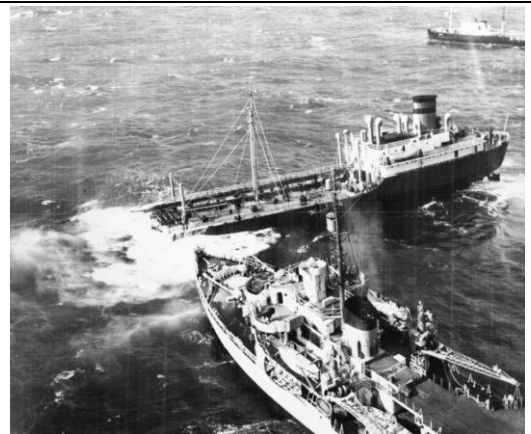
圖 4『彗星輪』折斷後艙部維持正浮 網路相似照片[3]
