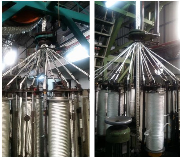
(圖四) 在有拉力情況下編織各種市場所需纜繩 資料來源：作者
