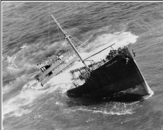
圖 3『彗星輪』折斷後艙部下沉中 網路相似照片[3]
