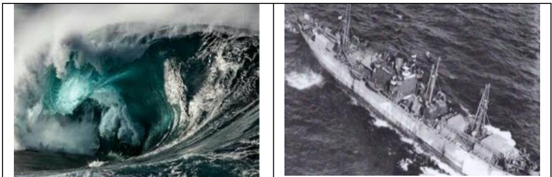
圖 42 自由輪脆弱的艙蓋結構，無法承受厚實的巨浪衝擊
