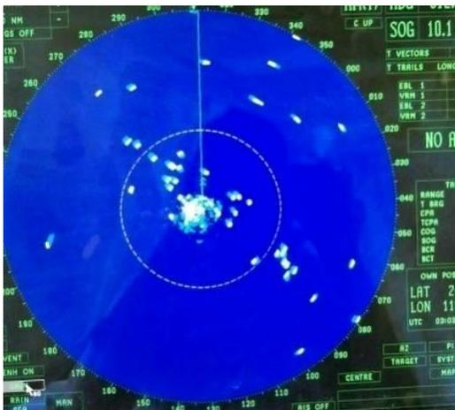
圖3 雷達對目標密集掃描，距離越遠回跡越大，有效範圍內不可能會有跳脫漏失的可能(除潛艇潛航或沉掉的船外)
